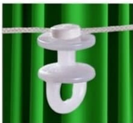
ślizg na sznurku dł. 1,5cm średnica otworu 0,45cm śr. kółka górnego 0,9cm
